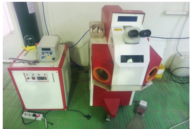
شکل 2- دستگاه جوش لیزر پالسی
