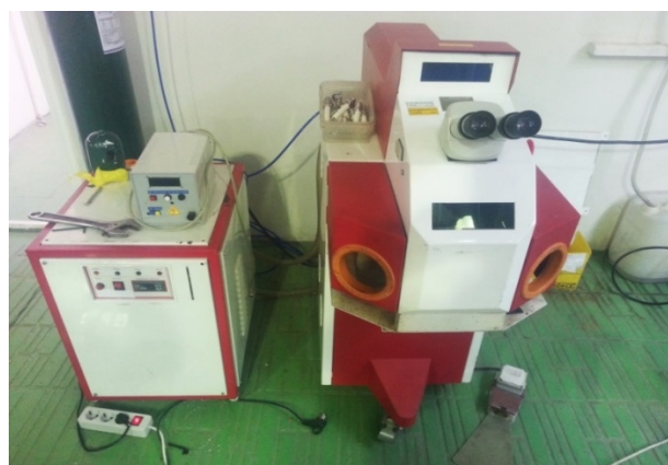
شکل 2- دستگاه جوش لیزر پالسی
