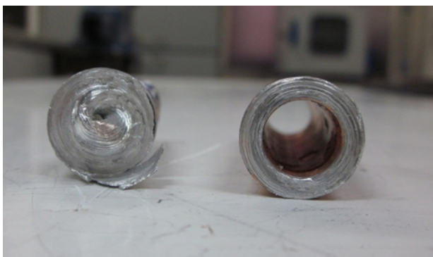
شکل 16- نحوه شکست نمونه‌های گروه سوم
