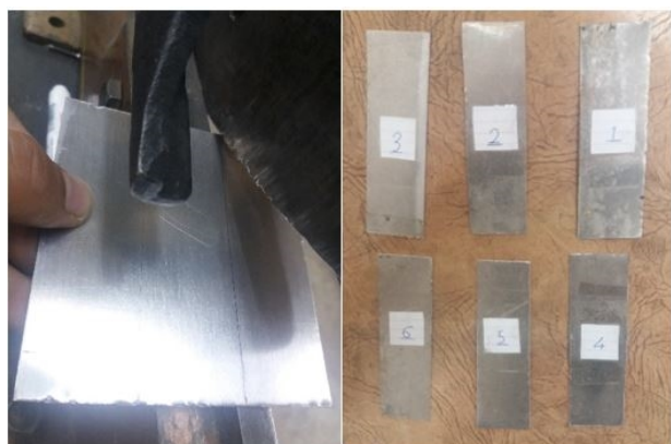
شکل 2- آماده سازی و برش کاری نمونه‌های شاهد
