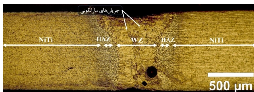
شکل 1- تصویر میکروسکوپ نوری از ریزساختار اتصال با مدت زمان اعمال پالس 5 میلی‌ثانیه.
