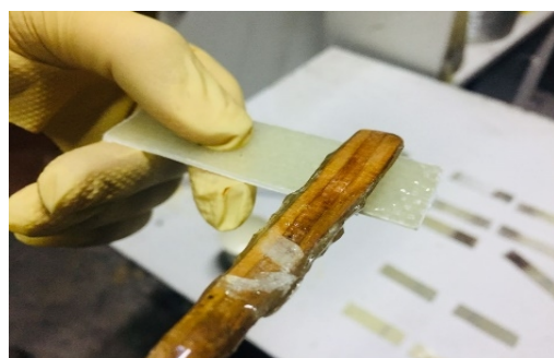
شکل 4- چسب کاری قطعه سطح صاف
