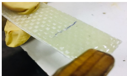
شکل 6- چسب کاری قطعه سطح زیر
