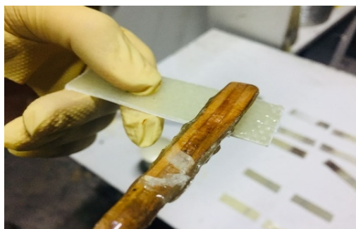
شکل 4- چسب کاری قطعه سطح صاف
