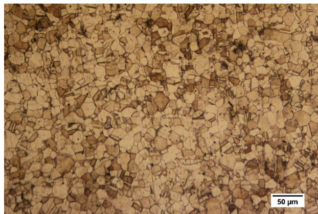
شکل 1- ریزساختار فولاد AISI 316L.
