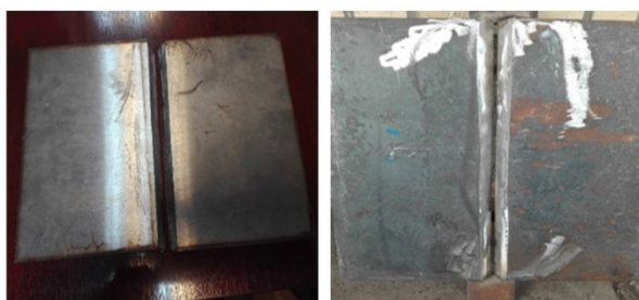
شکل 1- نمونه‌های برشکاری شده از آلیاژهای SA516-GR60 و
