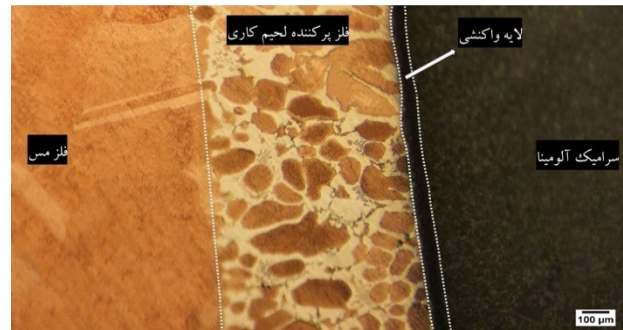
شکل 6- تصویر میکروسکوپی نوری اتصال لحیم کاری آلومینا به مس با فلزپرکننده Ag-Cu-Ti-Sn-3.5Zr .
