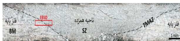
شکل 1- ماکروساختار نمونه جوشکاری شده. ناحیه مورد بررسی توسط آنالیز EBSD به وسیله مستطیل قرمز مشخص شده است.
