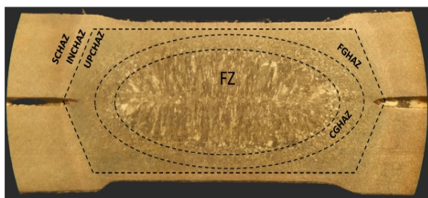
شکل 9- تصویر درشت ساختار مناطق و نواحی مختلف دکمه جوش.
