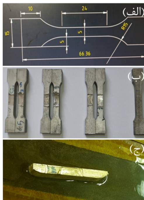
شکل 6-الف - شماتیک نمونه تست کشش، ب - تصویر نمونه‌های تست کشش و ج - نمونه متالوگرافی.
