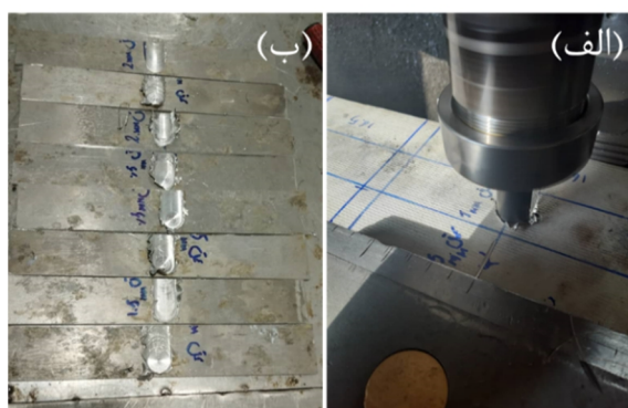
شکل 4- الف فرایند ترمیم و ب - نمونه‌های ترمیم شده.
