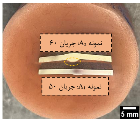
شکل 3- مقطع عرضی نمونه های A1، A2.
