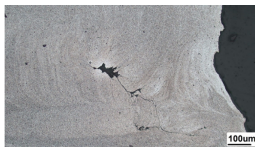
شکل 24- حفره‌های قابل مشاهده در نمونه 2 میلی‌متری.
