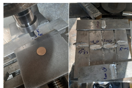
شکل 4- نحوه ترمیم ترک ورق آلومینیومی 7075.
