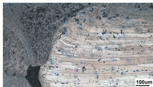
شکل 23- حفره‌های قابل مشاهده در نمونه 0.5 میلی‌متری.
