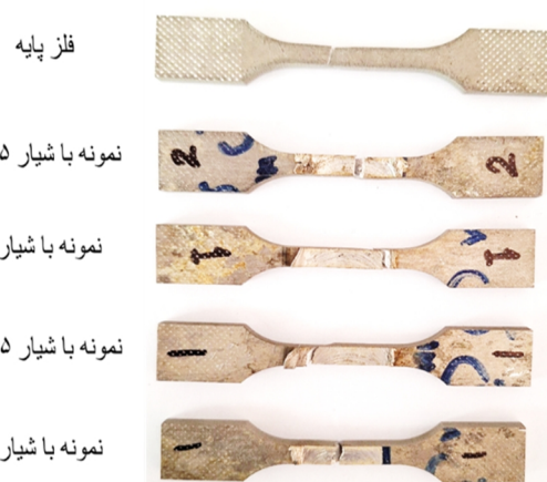
شکل 30- تصویر نمونه‌ها بعد از تست کشش.
