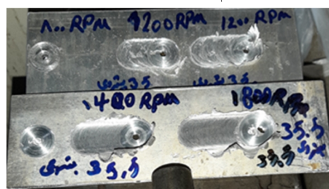
شکل 3- جوشکاری و تست مرحله دوم برای ورق 5052.
