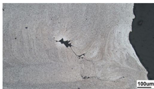
شکل 24- حفره‌های قابل مشاهده در نمونه 2 میلیمتری.
