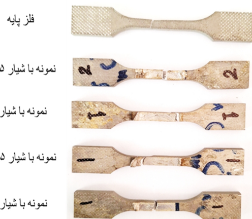
شکل 30- تصویر نمونه‌ها بعد از تست کشش.
