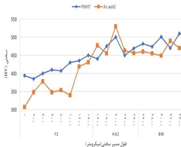
شکل 14- مقایسه سختی نواحی مختلف جوش نمونه جوشکاری شده بدون اعمال سیکل عملیات حرارتی پس از جوش و نمونه جوشکاری شده با اعمال سیکل عملیات حرارتی پس از جوش.
