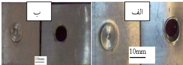
شکل ۶- گسیختگی جوش از محل دایره محاط بر دکمه جوش برای زمانهای نگهداری ابزار الف) ۶ ثانیه و ب) ۱۰ ثانیه.
