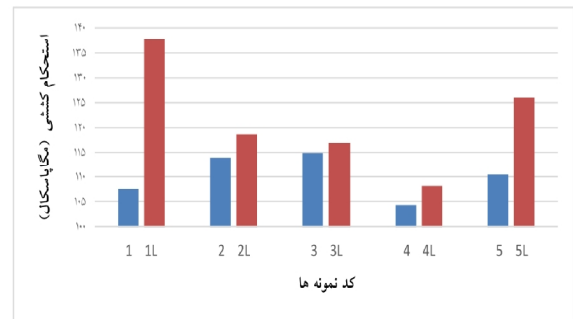
شکل 10- مقایسه استحکام کششی نمونه های جوشکاری شده با و بدون استفاده از لایه میانی به روش اصطکاکی اغتشاشی.
