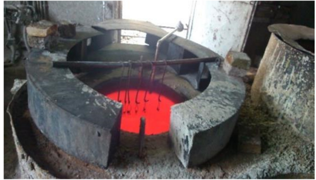
شکل 4- عملیات حرارتی نمونه ها در کوره
