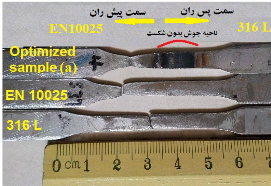
شکل 21- نمونه های آزمایش کشش نمونه بهینه با فلزات پایه.
