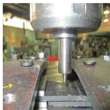
شکل ۳- مجموعه دستگاه فرز و فیکسچر جوشکاری
