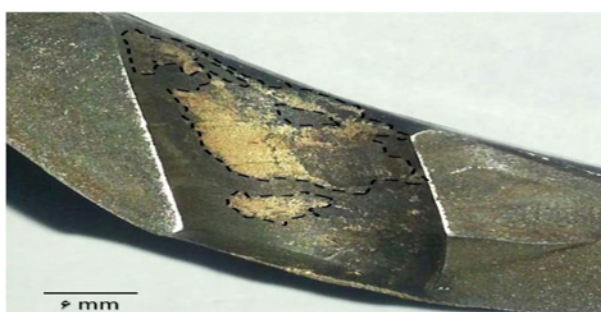
شکل ۶- عدم پیوستگی فلز لحیم باقی مانده درون سوراخ ایرفویل پره.
