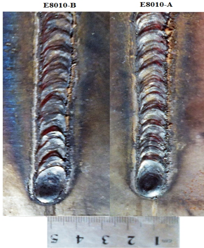
شکل ۷- خط جوش حاصل از جوشکاری الکترودهای E8010-A و E8010-B در حالت عمودی سرازیر
