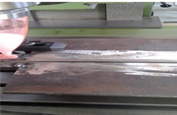
شکل 2- توزیع نانو مواد در طرح اتصال جوش
