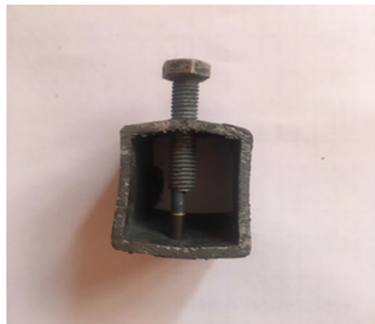
شکل 2- نحوه قرارگیری نمونه ها در فیکسچر
