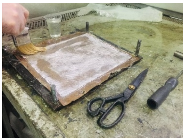
شکل 2- ساخت نمونه های پلیمری گرماسخت تقویت شده با الیاف شیشه.
