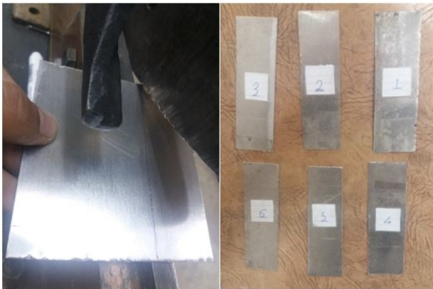
شکل 2- آماده سازی و برش کاری نمونه‌های شاهد
