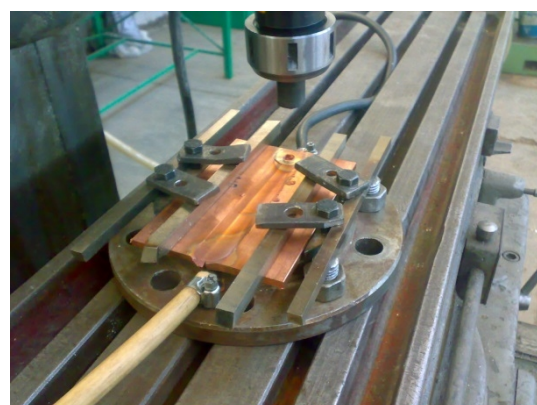
شکل 1- قالب جوشکاری مجهز به سیستم خنک کننده.
