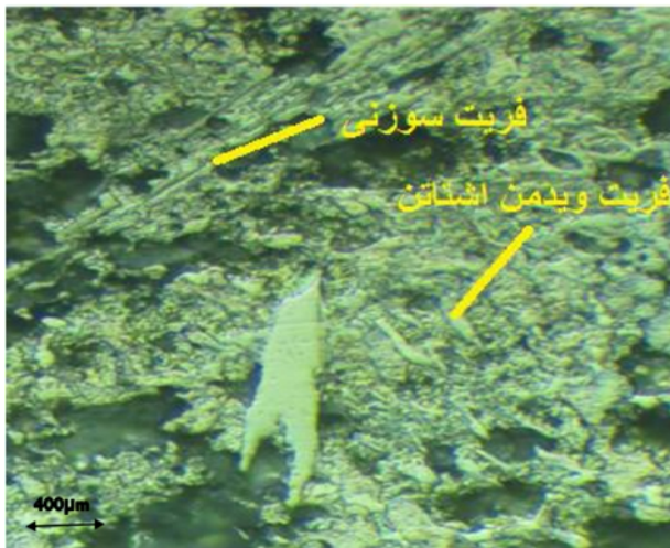
شکل 6- تصویر میکروسکوپی نوری از ریز ساختار منطقه متأثر از حرارت شامل فريت ويدمن اشکاتن و فريت سوزنی.
