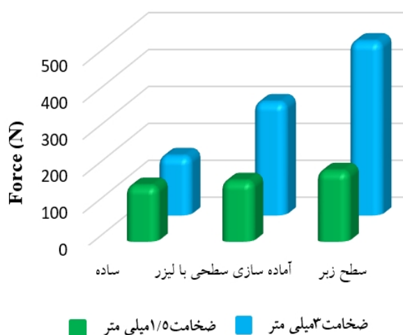
شکل 9- مقایسه استحکام کششی نمونه ها
