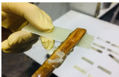
شکل 4- چسب‌کاری قطعه سطح صاف
