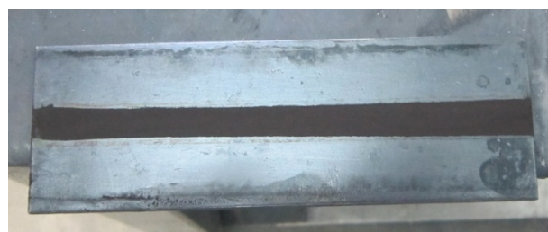
شکل 1- نمونه آماده سازی با پودر CuO.
