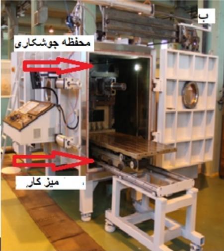
شکل 1- دستگاه جوشکاری پرتو الکترونی مورد استفاده در این تحقیق الف- تجهیزات خلأ ب- محفظه داخلی و میز کار.
