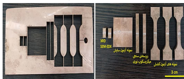
شکل 3- تهیه نمونه‌های استاندارد از کامپوزیت Cu-Ag-SiC به منظور بررسی ریزساختاری و خواص مکانیکی.
