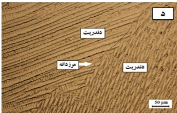
شکل ۲- ریزساختار فلز جوش اینکونل ۸۲ در نزدیکی خط جوش (الف) نحوه ی رشد رقابتی (ب) تصویر مرزهای مهاجرت کرده در بزرگنمایی بالا، (ج) ریزساختار فلز جوش اینکونل ۶۲۵ از نزدیکی خط ذوب تا مرکز فلز جوش (د) ساختار فلز جوش فولاد زنگ نزن 316 L نحوه ی رشد دندریتی در دو پاس مختلف
