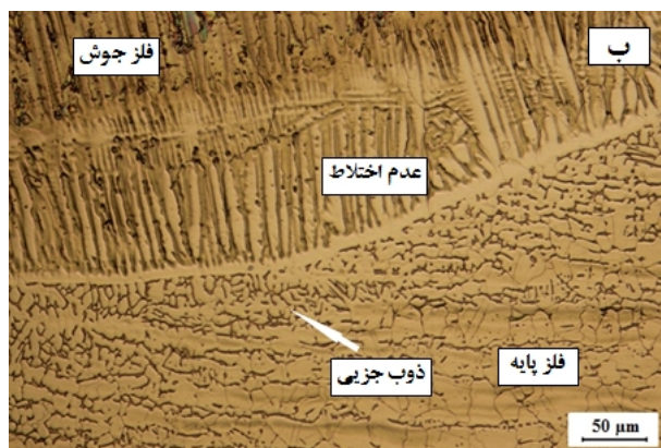
شکل ۹- فصل مشترک فلز جوش اینکونل ۶۲۵ با فلز پایه اینکولوی ۸۲۵ (الف) و با فلز پایه فولاد 316L (ب)
