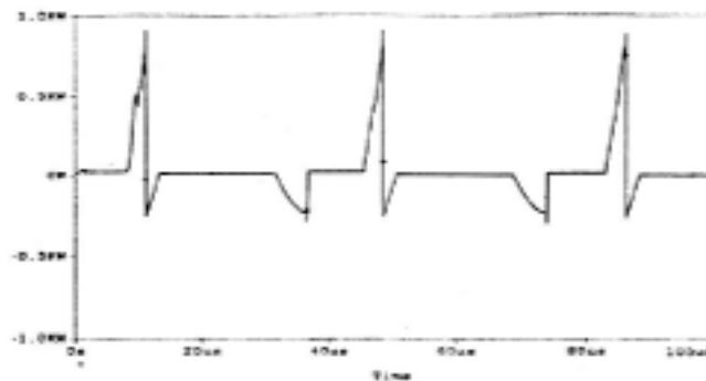
شکل ۷- انرژی تلف شده در لینک dc شبه رزونانسی، حاصل از شبیه سازی رایانه‌ای، اینورتر شکل ۳
