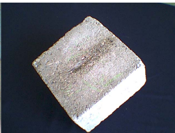
شکل ۷- نمونه R.C.C ساییده شده
