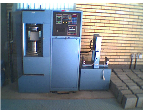
شکل ۱۰- دستگاه تعیین مقاومت فشاری
