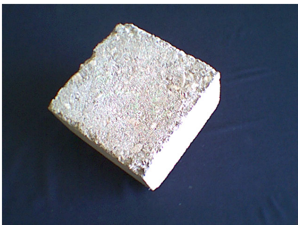
شکل ۶- نمونه R.C.C ساییده نشده
