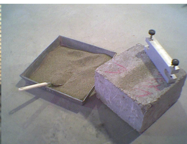
شکل ۹- طریقه تعیین جرم ساییده شده
