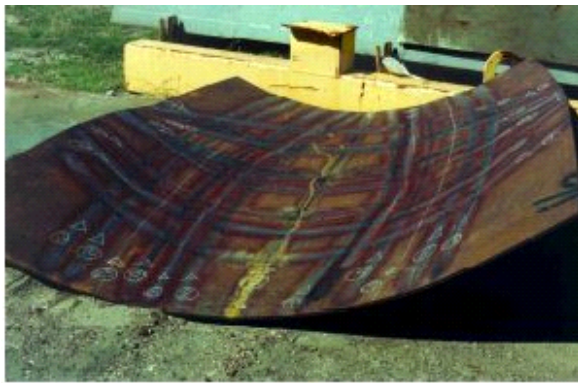
شکل ۲- نمونه‌ای از ورقهای شکل داده شده به روش خمکاری شعله‌ای
