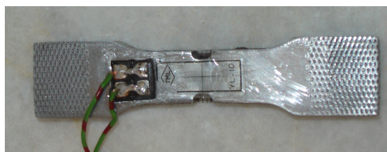
شکل ۲- نمونه شیاردار تهیه شده برای تعیین پارامترهای آسیب
