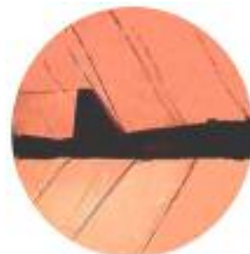
شکل ۳-ز) حرکت موج ناپایا روی بخش انتهای مدل با دم عمودی دوتایی، \alpha=0
