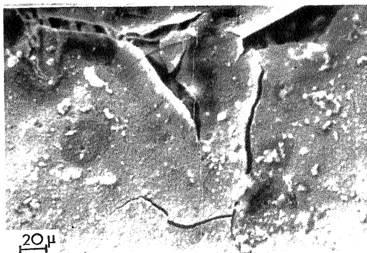
شکل ۱۵ : تصویر میکروسکوپی الکترونی از رسوبات ضخیم و غنی از آرسنیک که بر روی سطح نمونه خوردگی تنش تشکیل شده و ترک خورده اند . محلول : محلول پایه حاوی 500ppm آرسنیک سرعت کشش : 3/3 \times 10^{-2} میکرون بر ثانیه
