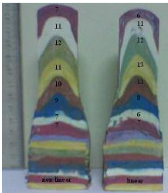
شکل ۲۰ - ضخامت لایه‌ها بر روی محور اکستروژن
