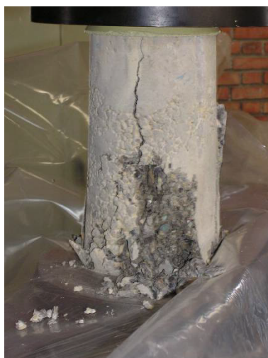
شکل ۱- وضعیت شکست در بتن معمولی
