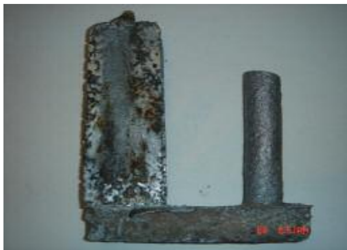
شکل ۵- نمایی از اولین قطعه تولید شده به روش حاضر که پر از حفره و سوراخ است.
