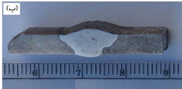
شکل ۱۱- الف) توزیع دمایی در مقطع طولی مدل در قسمتی از پاس اول (سمت چپ) و پاس دوم (سمت راست) و ب) تصویر متالوگرافی سطح مقطع عرضی جوش در نمونه S۲.
