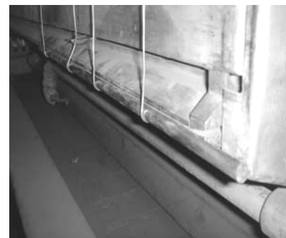
شکل ۲۷- نمای جانبی استوانه‌ها با دو قطر متفاوت، نمایی از محل قرارگیری استوانه در لبه زیرین جت و نحوه بستن استوانه به لبه زیرین یکی از جتها
