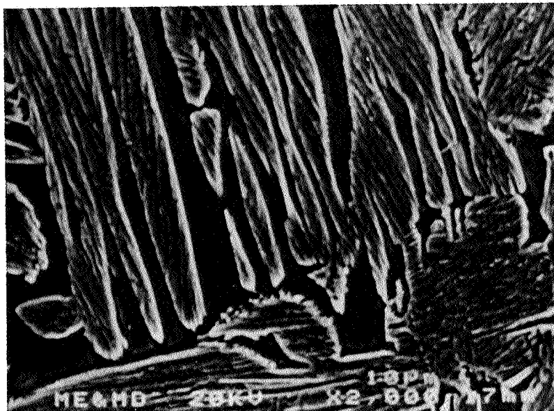
شکل ۸ - تصویر میکروسکوپی الکترونی از نمونه نشان داده شده در شکل شماره ۷ [نواحی آستنیت باقیمانده (نواحی هموار) و سوزنهای فریت بینیتی (نوی ناهموار) کاملاً مشخص اند]
