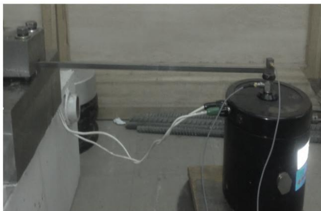
شکل ۳- تیر یک سر گیردار تحت آزمایش
