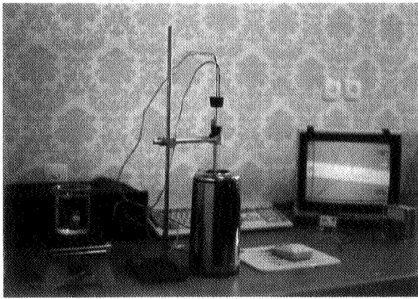
شکل ۴ - دستگاه اندازه‌گیر مقاومت الکتریکی برحسب دما
